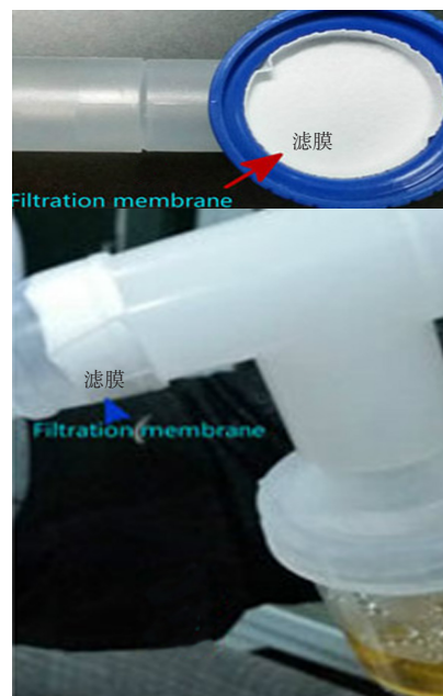
图2 应用聚丙烯微孔滤膜后的雾化器展示
