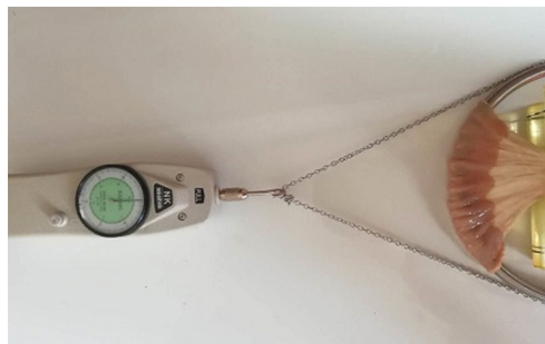
图1 破坏肠段并记录数据,橡胶棒固定住肠系膜,弯杆穿过小肠,通过绳索与拉力计连接
