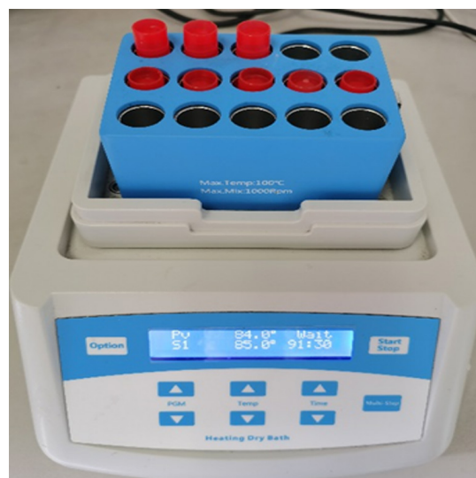
图1 专用离心管置于干式恒温器上加热熔化
